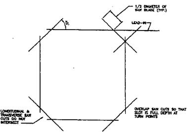
**LOOP SLOT CONSTRUCTION DETAIL**
